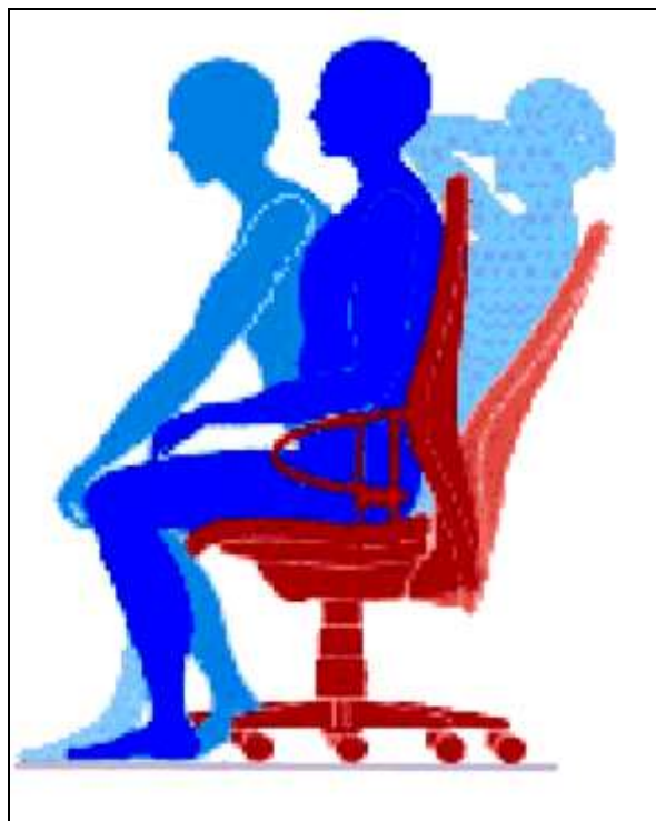
Bild 3 : Bürostuhl mit beweglicher (dynamischer) Lehne 1
