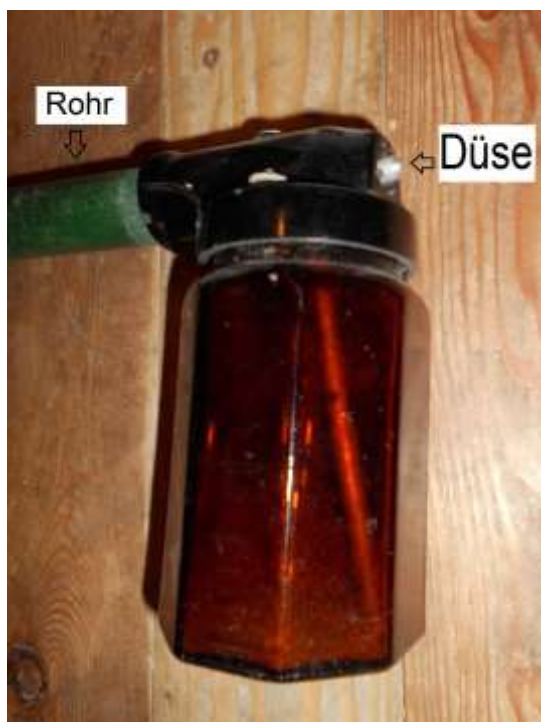
Bild 4: Die Sprühflasche des Electrolux-Staubsaugers (rechts aufgeschraubt)
