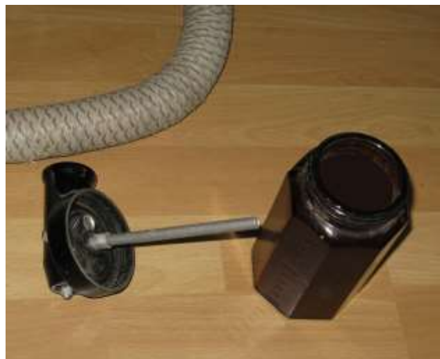
Bild 4: Die Sprühflasche des Electrolux-Staubsaugers (rechts aufgeschraubt)
