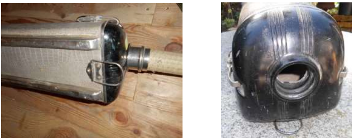
Bild 5: Die Saug-Seite mit Haken zum Aufhängen (ZF 55)
