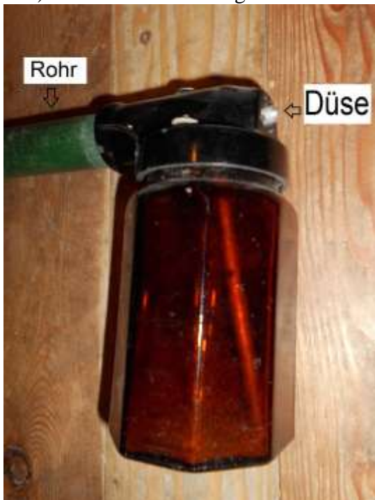
Bild 7: Die Sprühflasche des Electrolux-Staubsaugers (rechts aufgeschraubt)
