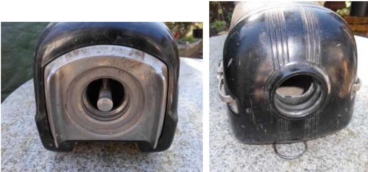
Bild 8: Ausblas-Öffnung und Saug-Öffnung des ZF 55
