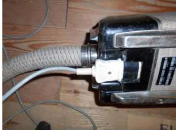
Bild 6: Ausblas-Öffnung (links) und Gerätestecker (rechts) des ZF 55
