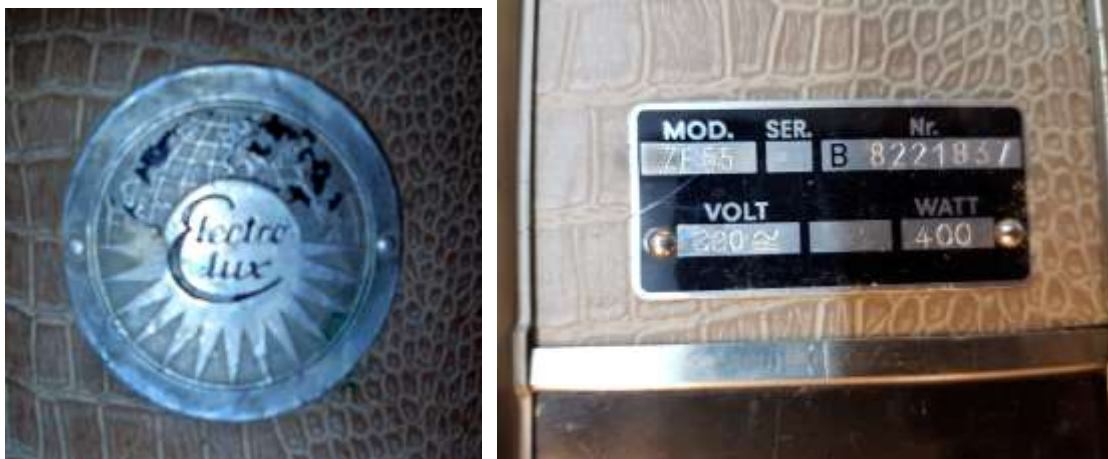
Bild 4: Electrolux-Plakette auf der Oberseite des Staubsauger ZF 55 (links) Typenschild auf der Unterseite (rechts)
