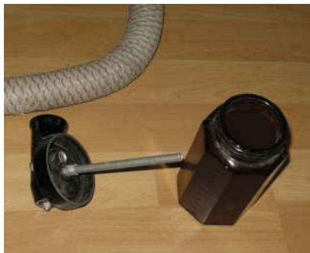
Bild 7: Die Sprühflasche des Electrolux-Staubsaugers (rechts aufgeschraubt)
