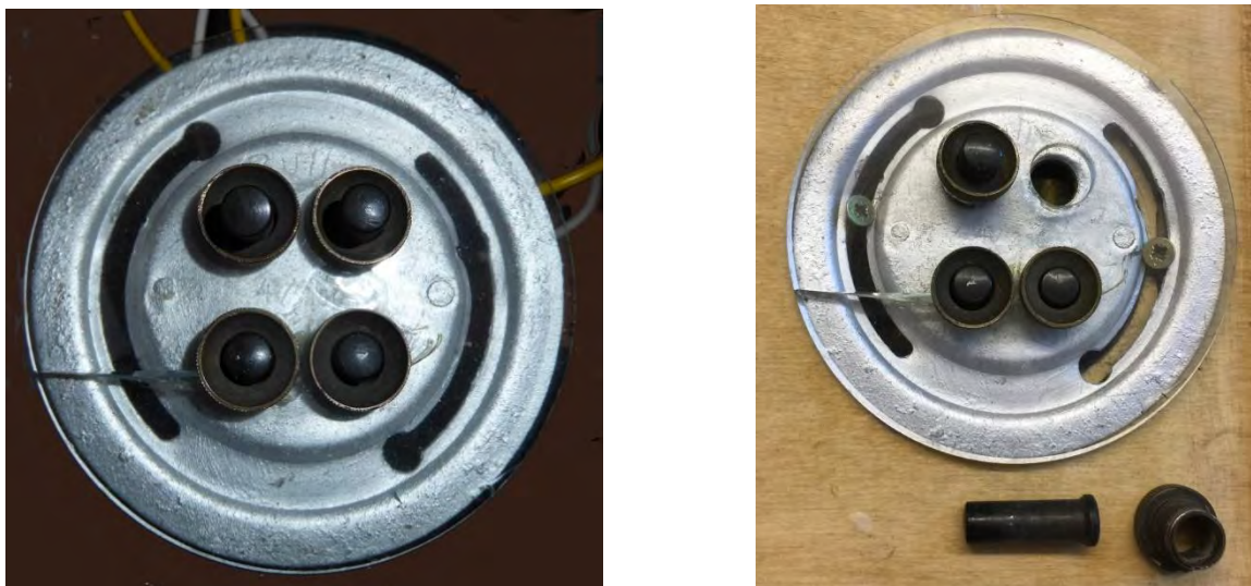
Bild 29: Unterputz-Serienschalter, Typ 'Bulla', beim Einbau in der Werkstatt
