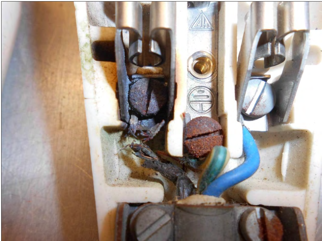
Bild 16: Verschmorte Kupplungsdose (Mai 2019)
