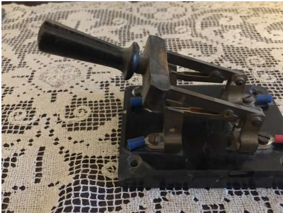
Bild 22: Beginn des Ausschaltvorgangs über zwei Federkontakte
