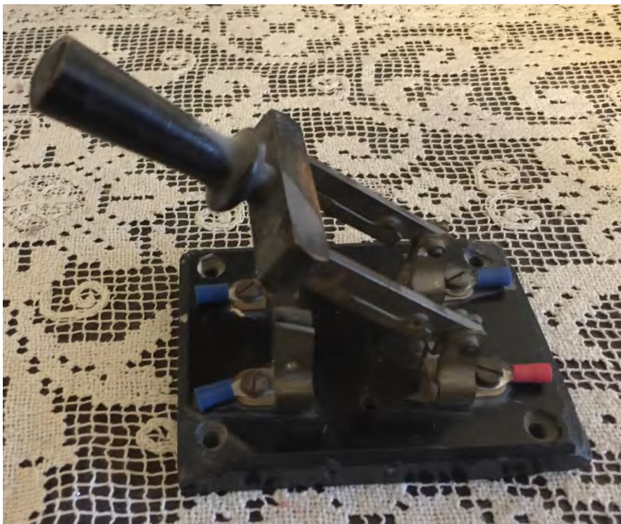
Bild 24: Ausgeschalteter Zustand (Messingfedern haben sich gelöst)
