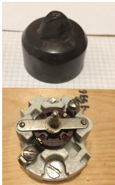
Bild 33: Aufputz-Drehschalter, mit abgenommenem Deckel
