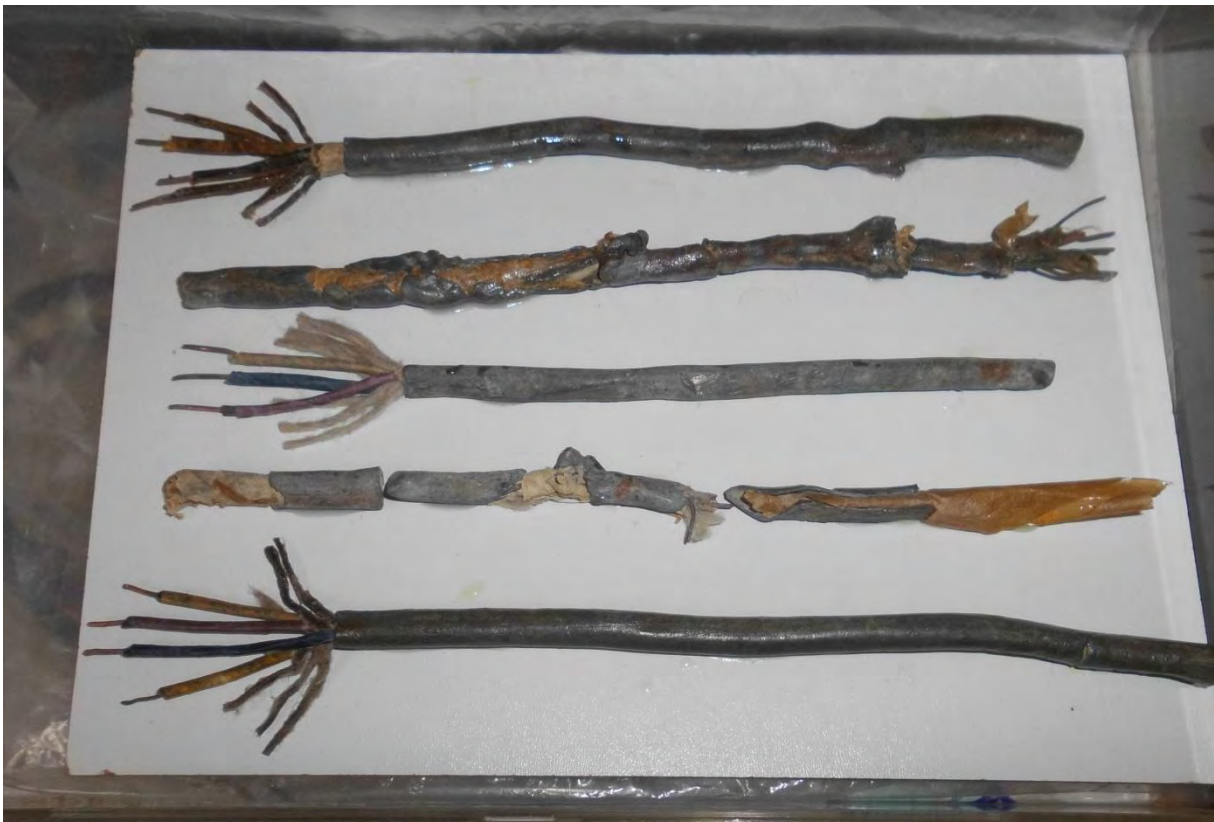
Bild 15: Klingelkabel mit Metallmantel, verschiedene Stücke
