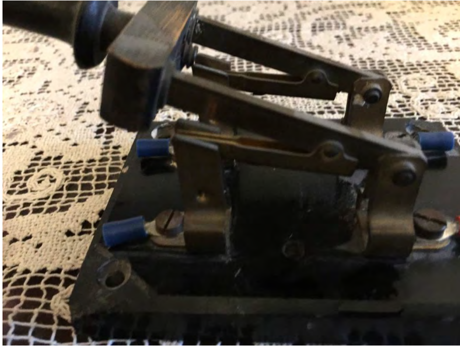
Bild 23: Ausschaltvorgang (Messingfedern kurz vor Kontaktabbruch)
