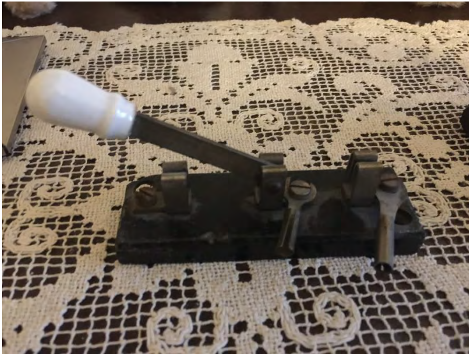
Bild 20: Kleiner Messerschalter mit Umschalt-Funktion 22
