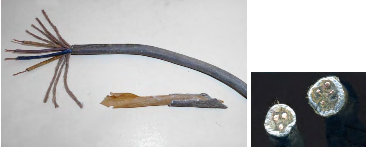
Bild 14: Klingelkabel mit Metallmantel (1937), links vieradriges Kabelstück, rechts Querschnitte, drei- und vieradrig
