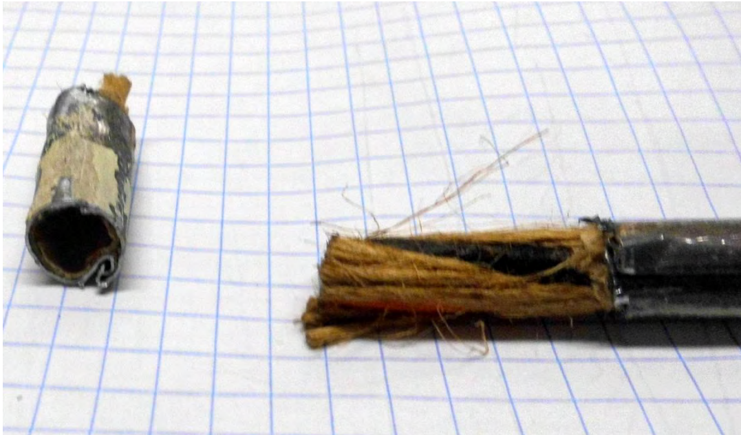
Bild 4: Entmanteltes Kabelstück und Mantel-Querschnitts-Ansicht ("Rohrdraht")
