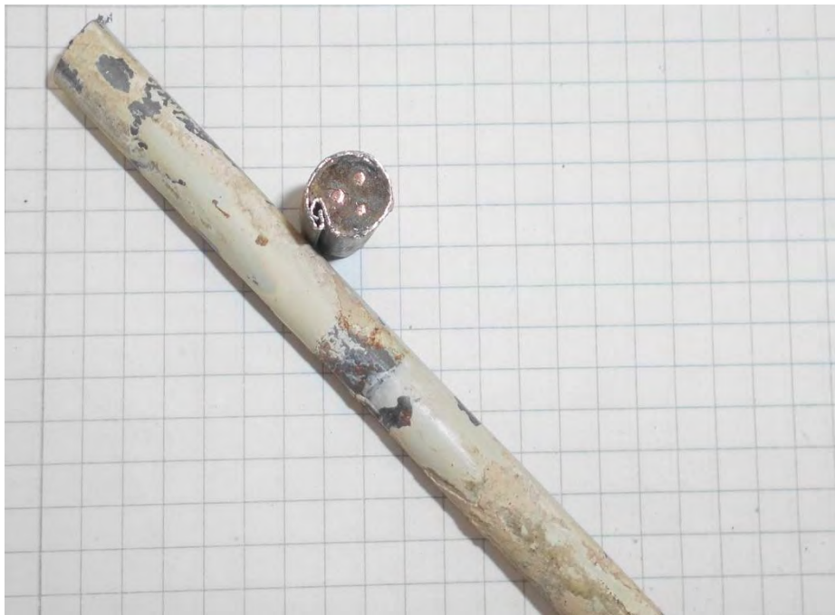
Bild 3: Kabelstück und Querschnitts-Ansicht ("Rohrdraht")
