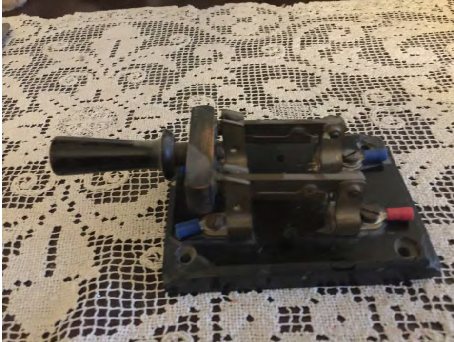
Bild 21: Zweipoliger Messerschalter, eingeschaltet
