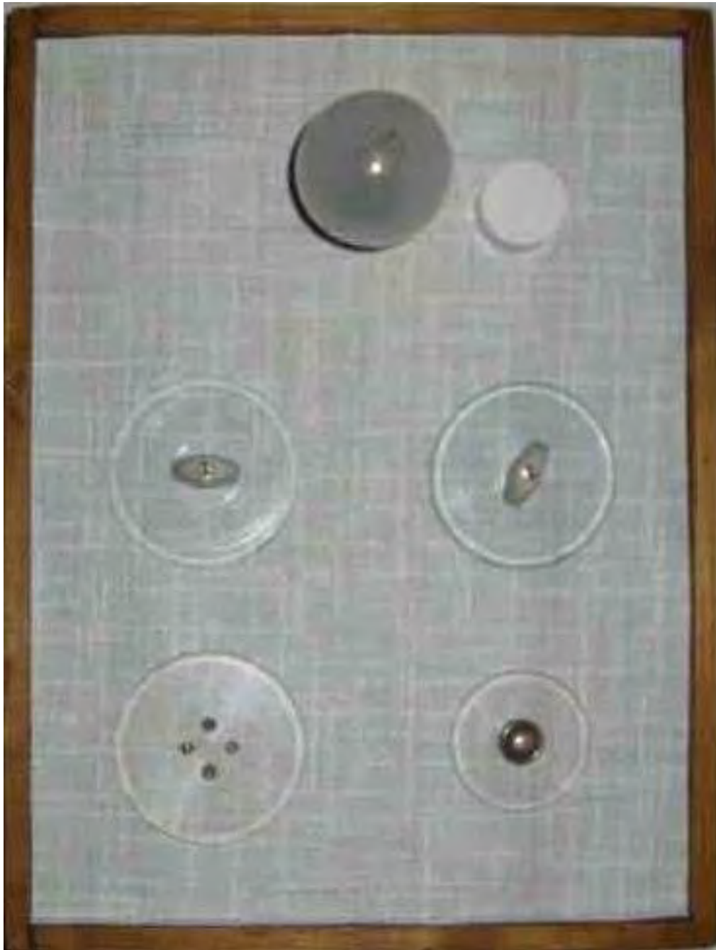
Bild 34: Schautafel mit Drehschaltern, einer Steckdose Klasse 0 und einem Klingelknopf
