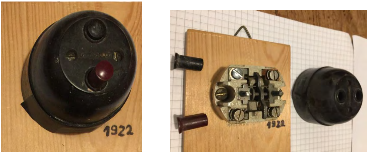
Bild 28: Aufputzschalter, Typ "Bulla" von 1922, rechts mit abgenommenem Deckel
