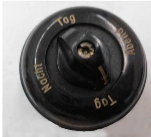
**Bild 21: Schalterstellungen der beiden Betriebsart-Umschalter**
