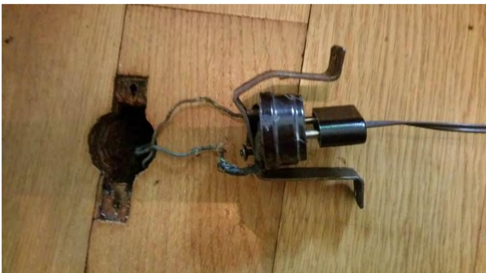
**Bild 11: Mini-Steckdose im Fußboden für einen mobilen Dienstbotenklingelknopf**
