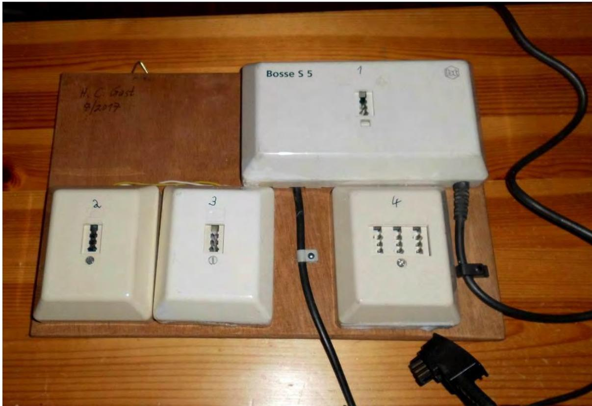
**Bild 2: Die Nebenstellenanlage für vier Analog-Telefone mit Impulswahl**
