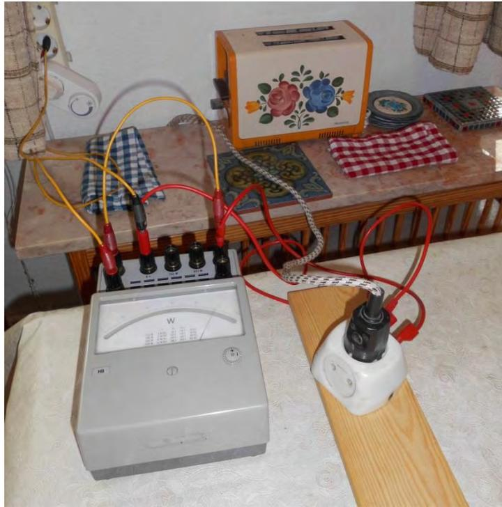
**Bild 37: Messung der Leistungsaufnahme eines Toaströsters**
