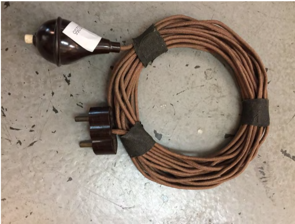
Bild 21: Birnenförmiger Klingelknopf mit Schnur für eine Dienstbotenklingel
