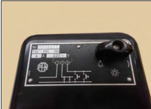
Bild 28: Schalterstellungen der beiden Betriebsart-Umschalter (links Schalter im Relais-Gehäuse, rechts ein separater Umschalter)
