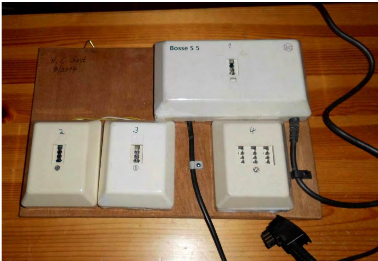
Bild 2: Die Nebenstellenanlage für vier Analog-Telefone mit Impulswahl
