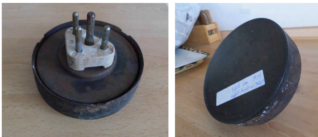
Bild 40: Austauschbare defekte alte Herdplatte von 1937
