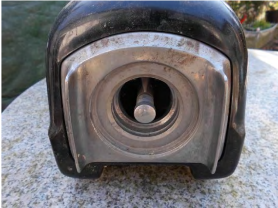
Bild 48: Ausblas-Öffnung (links) und Gerätestecker (rechts) des ZF 55
