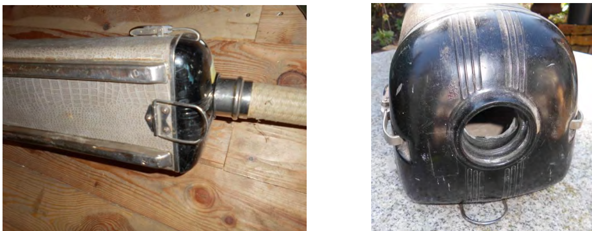
Bild 47: Die Saug-Seite mit Haken zum Aufhängen (ZF 55)
