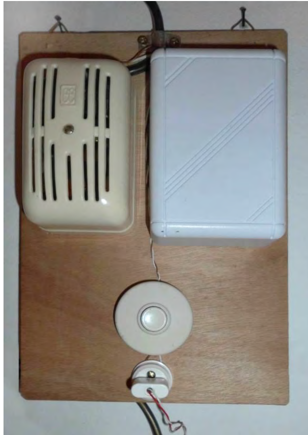
Bild 15: Schaubrett mit Ding-Dong-Klingel (Zweiklang-Gong) und Mini-Steckdose
