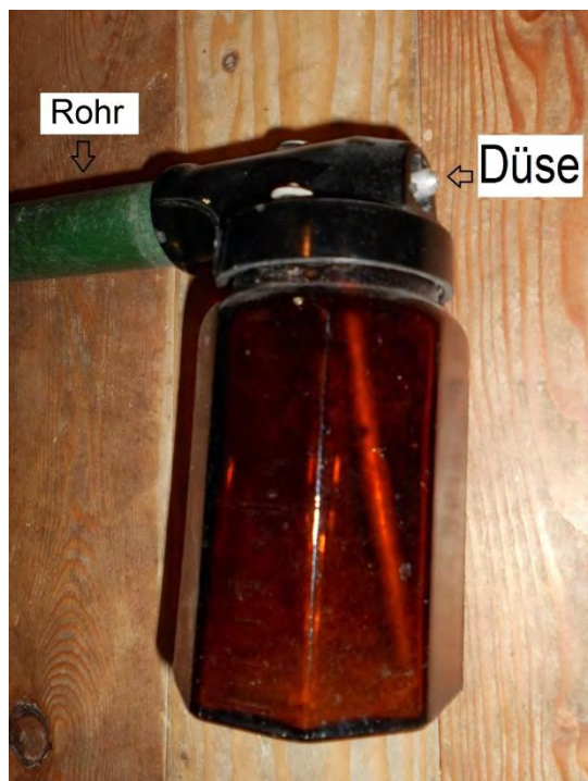
Bild 49: Die Sprühflasche des Electrolux-Staubsaugers (rechts aufgeschraubt)
