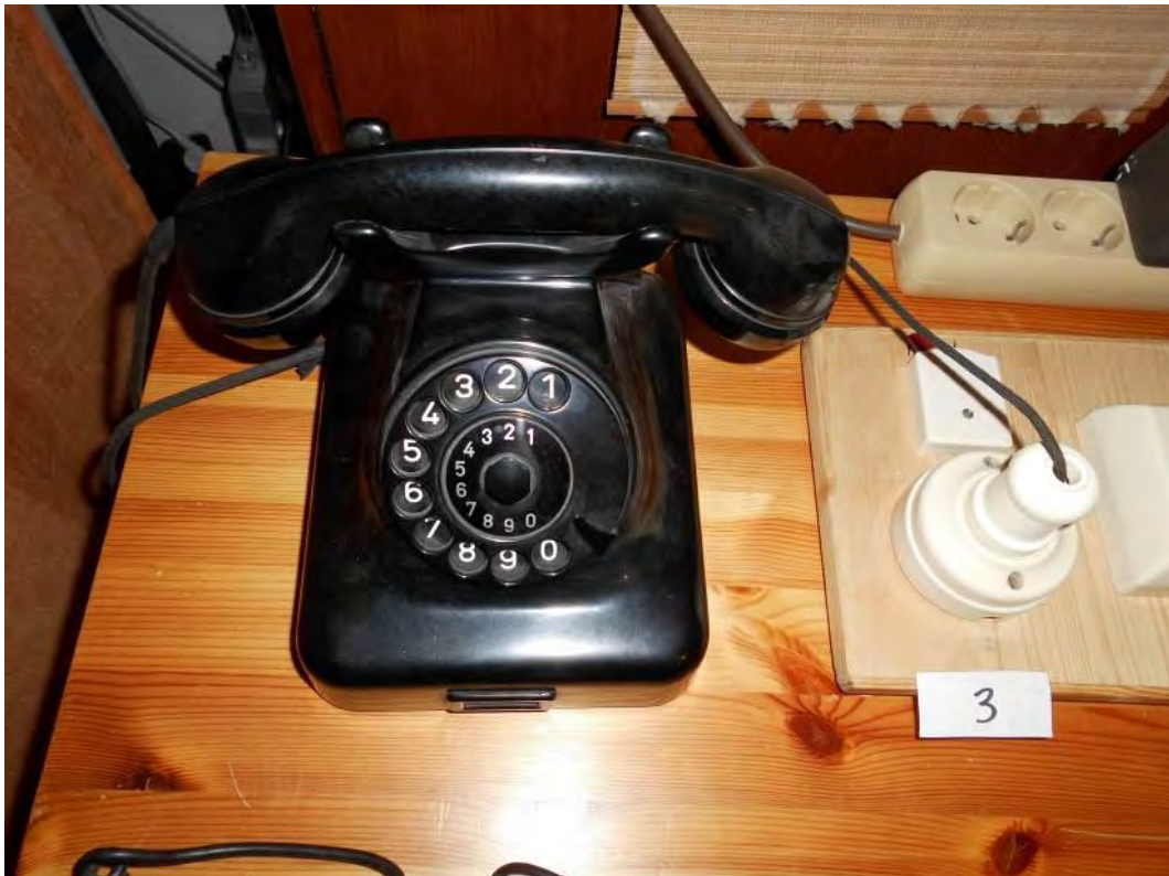
Bild 4: Altes schwarzes Telefon mit Wählscheibe (1956) und Walzenstecker
