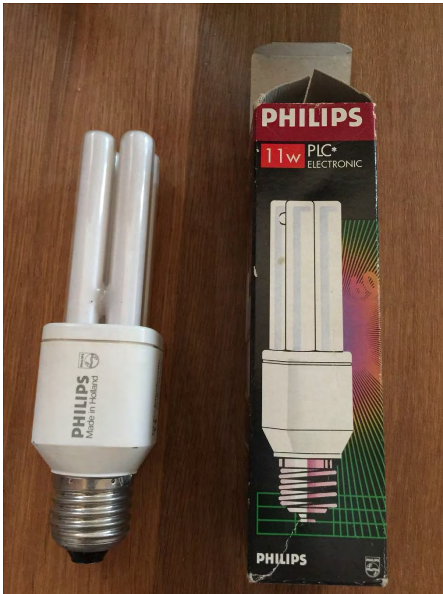
Bild 25: Energiesparlampe (Kompaktleuchtstofflampe) mit Original-Karton
