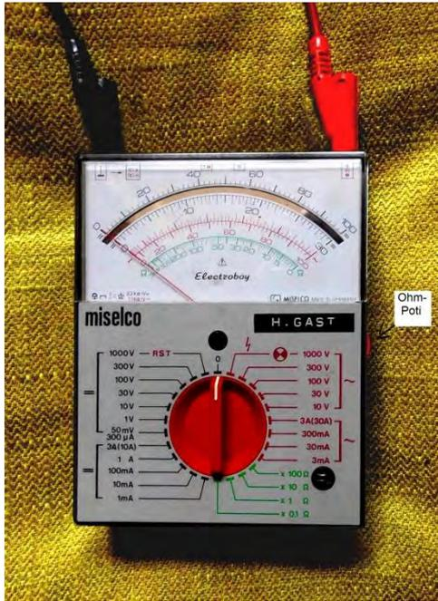
Das Gerät kann die Drehrichtung von Drehstrom und Wechselströme bis 30 A messen! Es kann ferner "0,1 Ohm" besser messen als mein erstes Digitales Messgerät! Der Messbereich 50 mV ist identisch mit dem Messbereich 300 µA. Das Zeigerinstrument hat folglich 167 Ohm(?) Es können zur Messung normale Bananenstecker-Schnüre verwendet werden.
