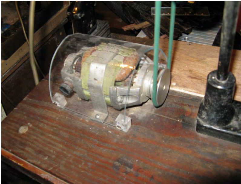
Bild 36: Abdeckung des Motors
