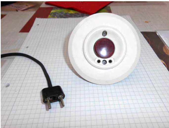
Bild 22: links Klingelknopf (Unterputz) mit Anschlusskontakt für mobilen Klingelknopf, rechts Anschlussbuchse (Aufputz) für mobilen Klingelknopf von 1937
