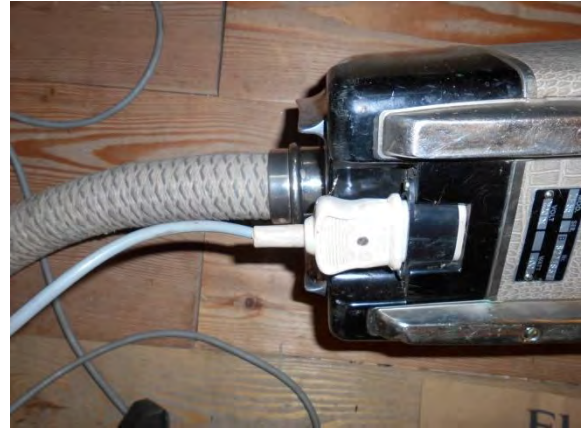
Bild 48: Ausblas-Öffnung (links) und Gerätestecker (rechts) des ZF 55
