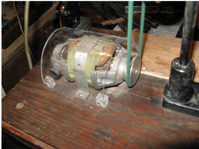
**Bild 28: Abdeckung des Motors**
