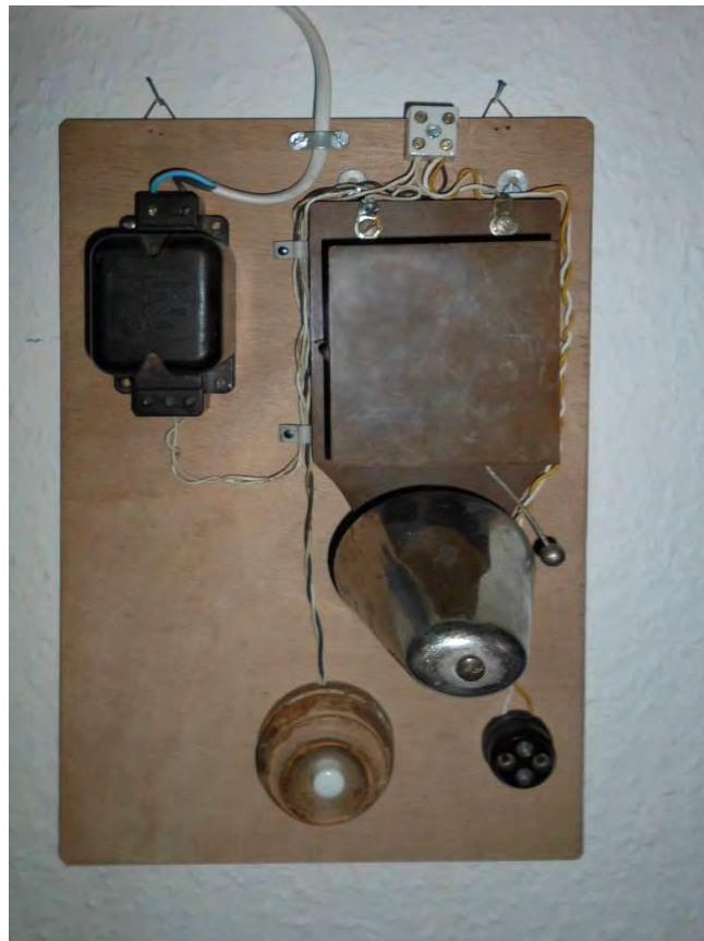
Bild 16: Schaubrett mit alter Holz-Klingel und Holz-Klingelknopf sowie Mini-Steckdose
