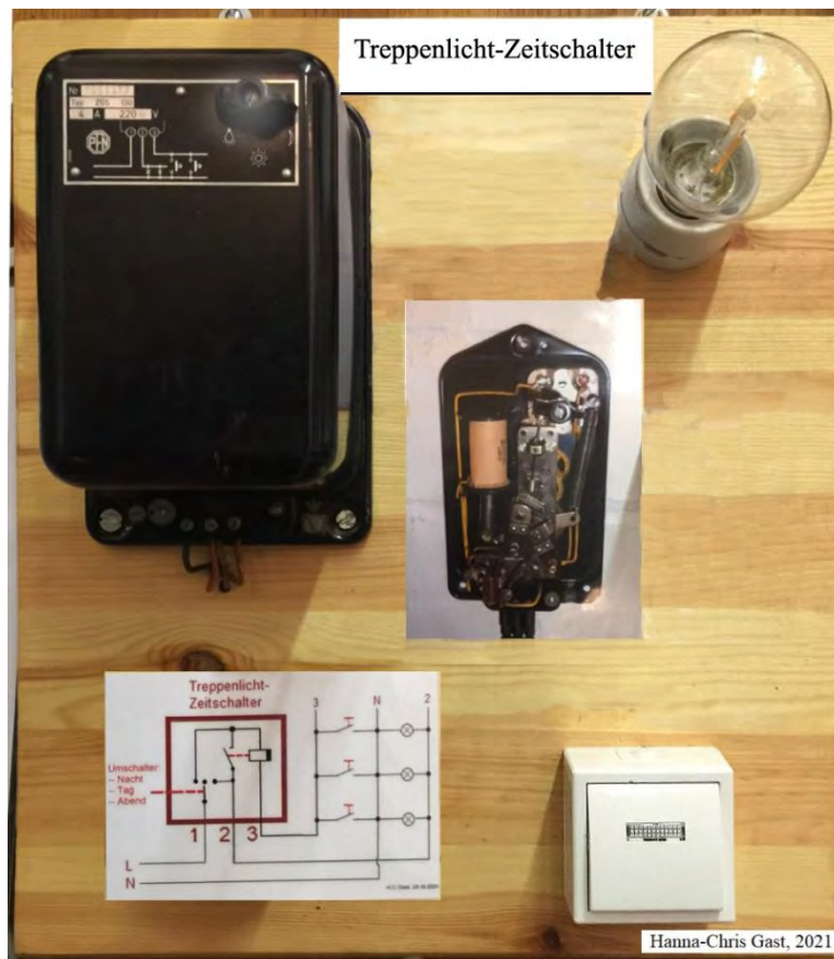
Bild 26: Aufbau mit Treppenlicht-Zeitschalter im Energie-Museum-Berlin (retuschiert)
