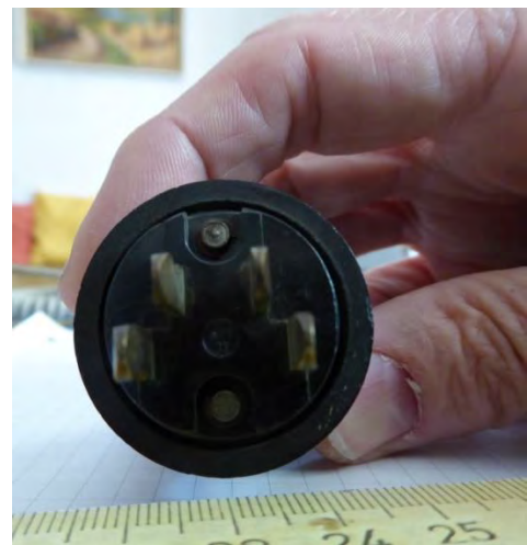
Bild 10: Telefonstecker der beiden Telefone
