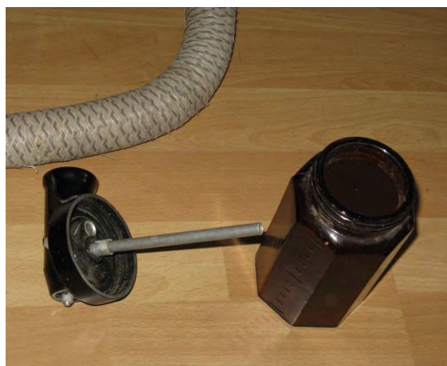
Bild 49: Die Sprühflasche des Electrolux-Staubsaugers (rechts aufgeschraubt)
