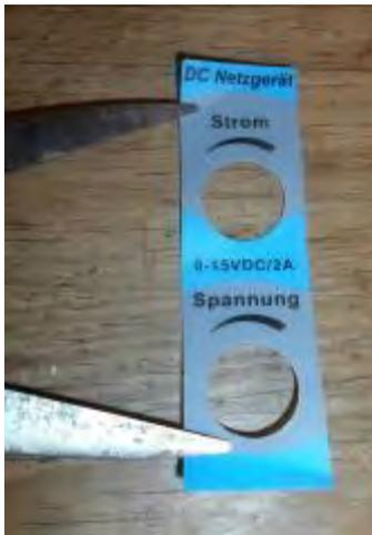
Darunter war eine Beschriftung, wie es sich gehört: Die Spannungseinstellung neben dem Voltmeter, und die Strombegrenzungseinstellung (fast) neben dem Amperemeter, siehe Bild rechts!
