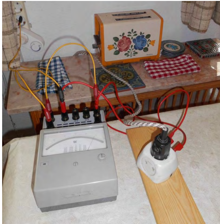
Bild 54: Messung der Leistungsaufnahme eines Toaströsters
