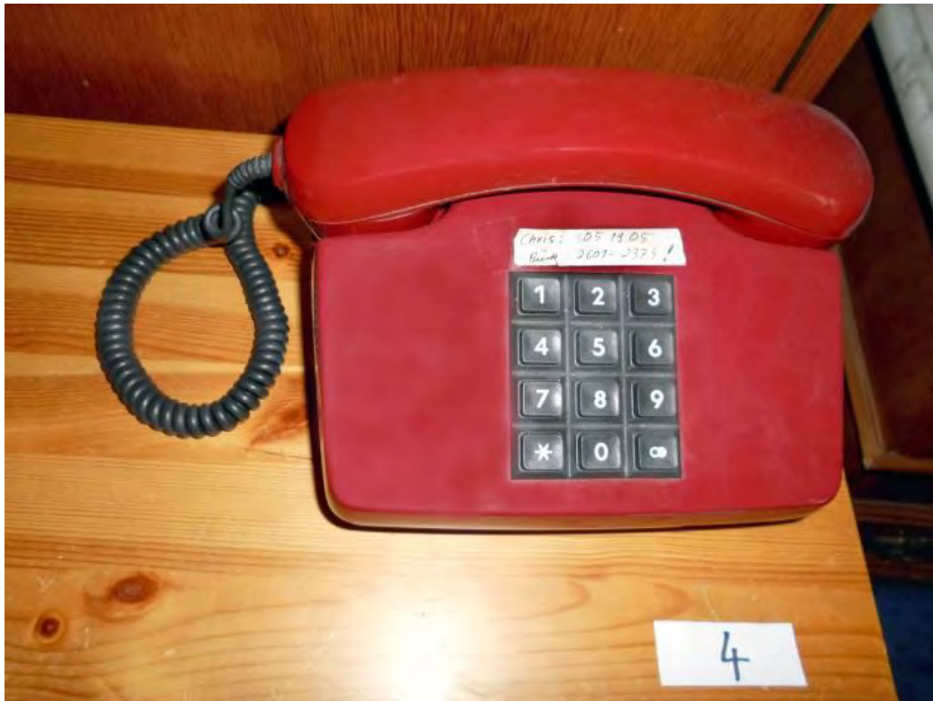
Bild 6: Rotes Telefon mit 12 Tasten für Impulswahl (1990)
